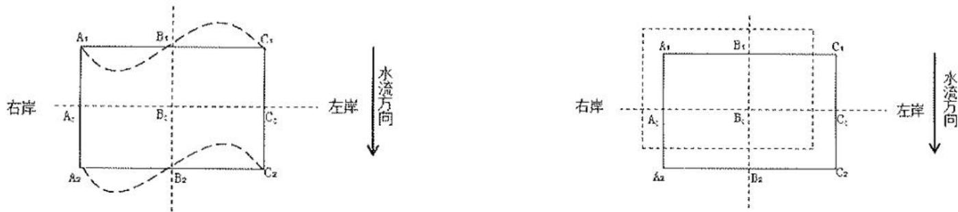
结构物 $A_1C_1C_2A_2$ ， $B_1B_2$ 和  $A_0C_0$ 分别为顺水流方向和垂直于水流方向的中线
